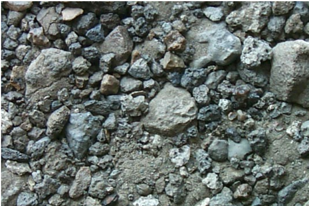
21AA Blast Furnace Slag – Actual size shown
