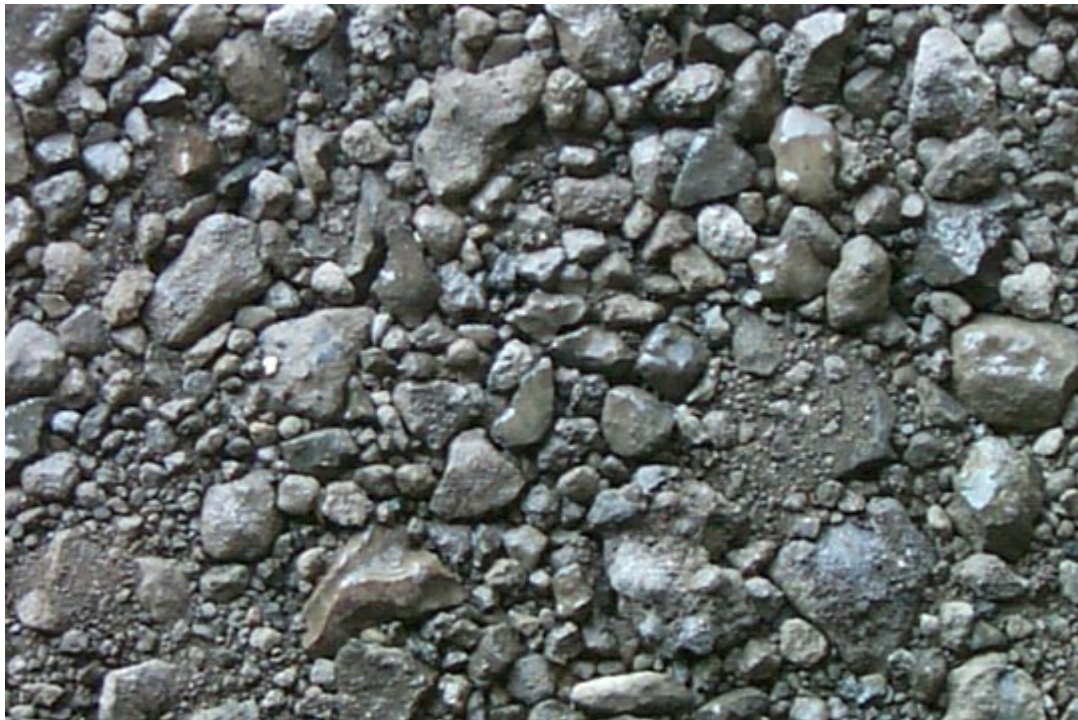
22X Steel Furnace Slag – Actual size shown
