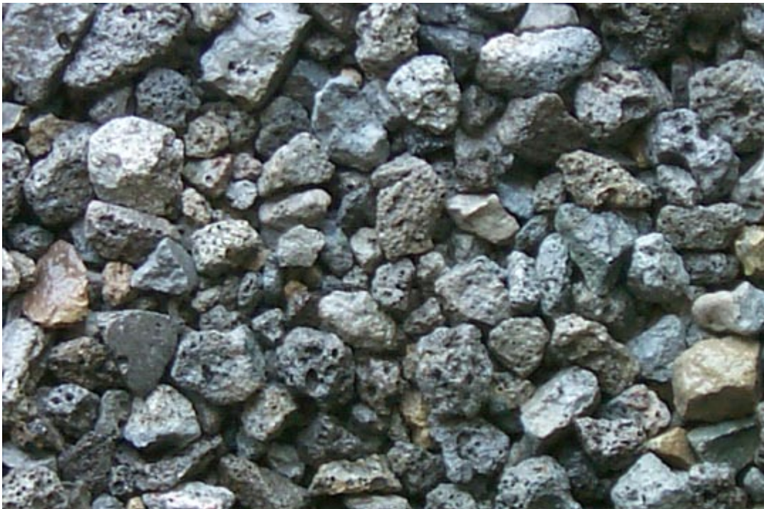
ASTM ¾ Roofing Blast Furnace Slag – Actual size shown
