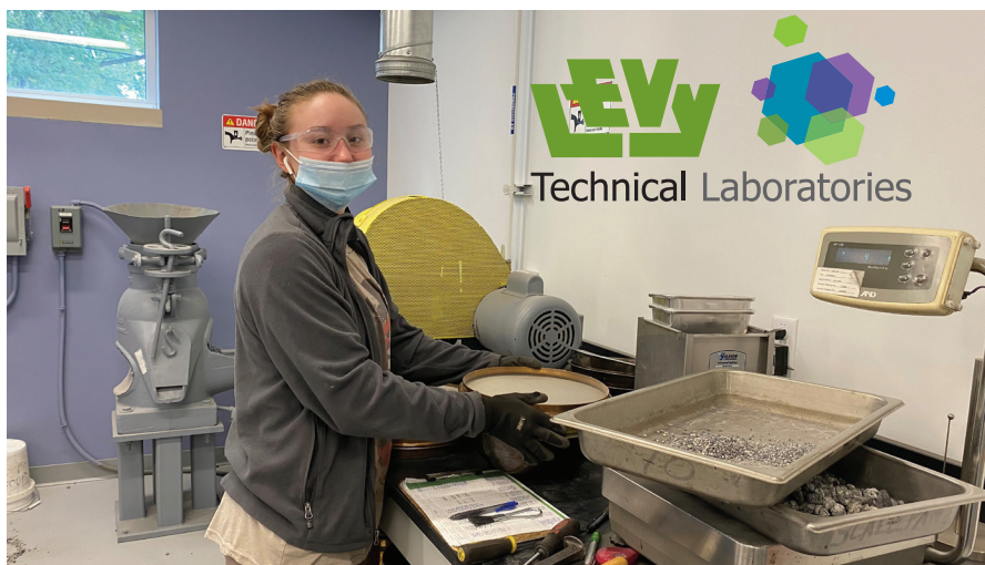
Lora Page, ingénieure contrôle qualité, effectue un test de gradation au sein des nouveaux laboratoires techniques Levy
