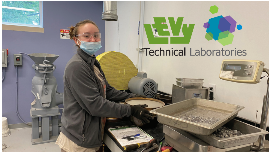
Lora Page ช่างเทคนิคด้านการควบคุมคุณภาพ กำลังทำการทดสอบขนาดละเอียด (Gradation test) ภายในห้องทดสอบทางเทคนิคของ Levy
